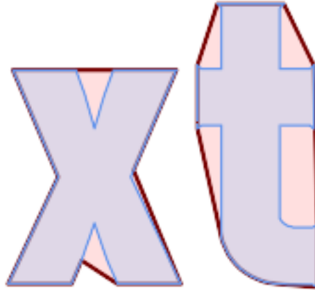
中間点を挿入したマルチポリゴンの外側の凹包による簡略化
